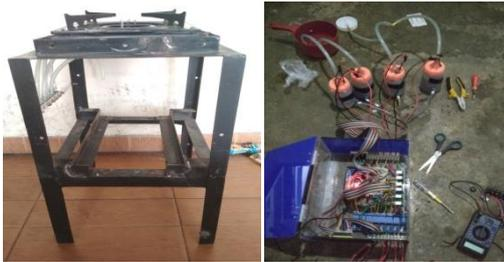
**Gambar 3** Kompor listrik dengan tabung elektrolisa
